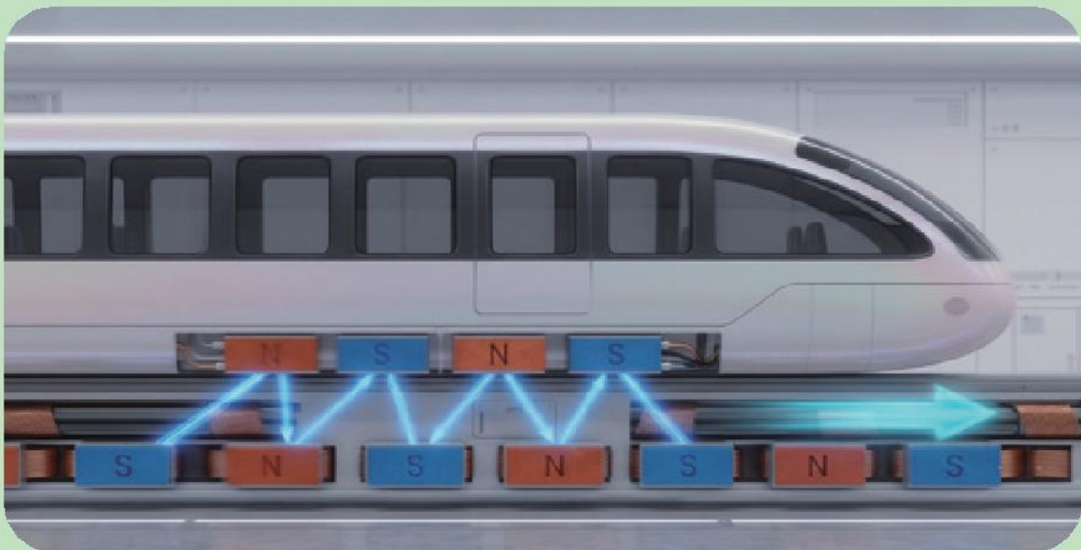
자기부상열차를 앞으로 달리게 하는 ‘직선형 전동기’의 이동 원리. 레일에 길게 깔린 코일의 자기장과 열차 하부의 전자석이 상호작용하여, 앞쪽 레일은 열차를 당기고 뒤쪽 레일은 밀어내는 연속적인 자기력을 통해 추진력을 얻는다.
