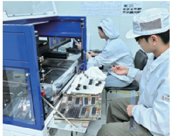
자체 기술력으로 구축한 제엠제코의 전력 반도체 패키징 자재 준비 및 검수 현장. 제엠제코는 패키징 소재부터 자동화 장비, 모듈 기술까지 전 과정을 내재화하여 전력 반도체 생태계 국산화에 도전하고 있다.
