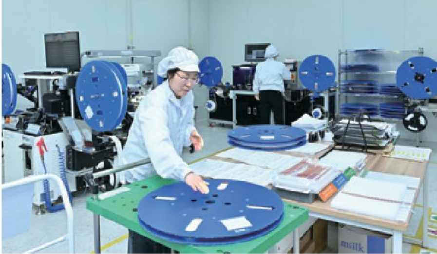
제엠제코 생산 라인에서 작업자가 전력 반도체 패키징에 사용되는 대형 릴 자재를 다루고 있다. 제엠제코는 전력 반도체 패키징 소재 양산과 후공정 자동화 장비 기술을 자체 개발해 전체 매출의 80% 이상을 해외 수출로 달성하고 있다.
