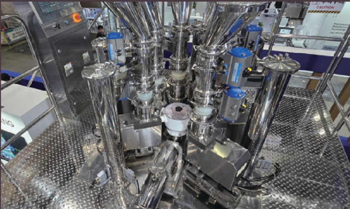
연속공정 기반 의약품 생산시스템의 원료 투입 및 혼합 공정 구조. 여러 호퍼를 통해 투입된 원료가 실시간으로 혼합·분석돼 배치에 구애받지 않고 경구용 정제로 제조된다.
