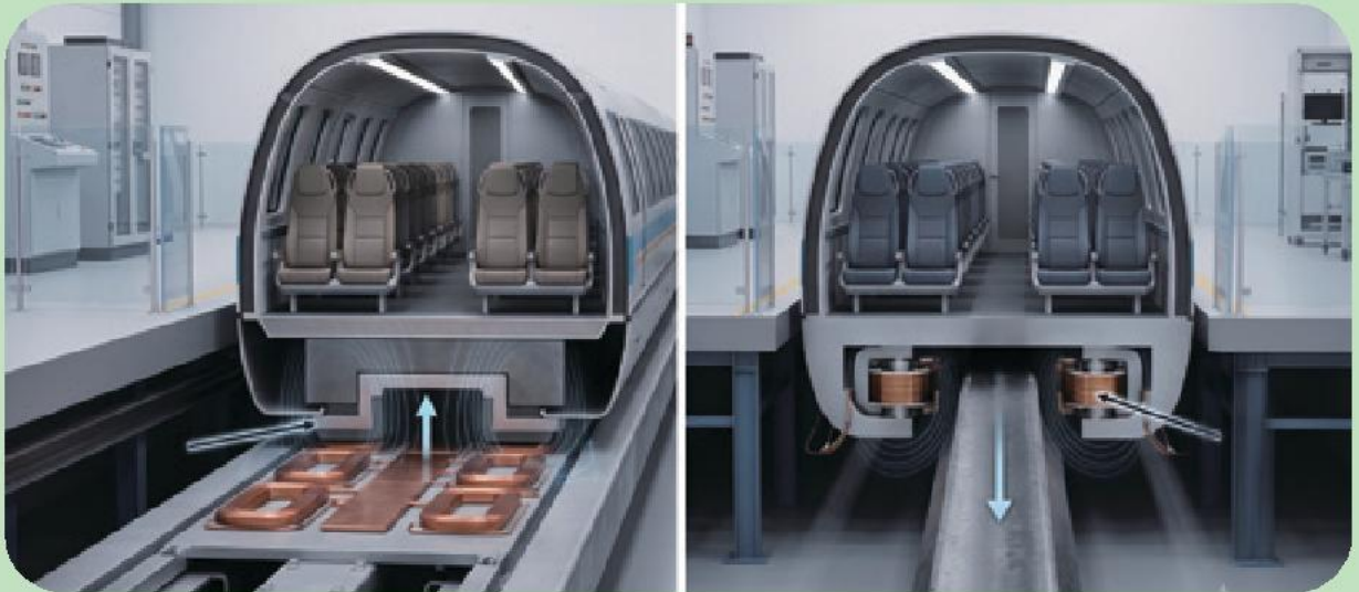
자기부상열차의 두 가지 핵심 부상 방식 단면도. 왼쪽은 차량 자석과 선로 코일이 상호작용하여 열차를 띄우는 EDS(전자기 유도 부상) 방식이고, 오른쪽은 열차 하부의 전자석이 레일을 감싸안고 위로 끌어당기는 EMS(전자기력 부상) 방식이다.
