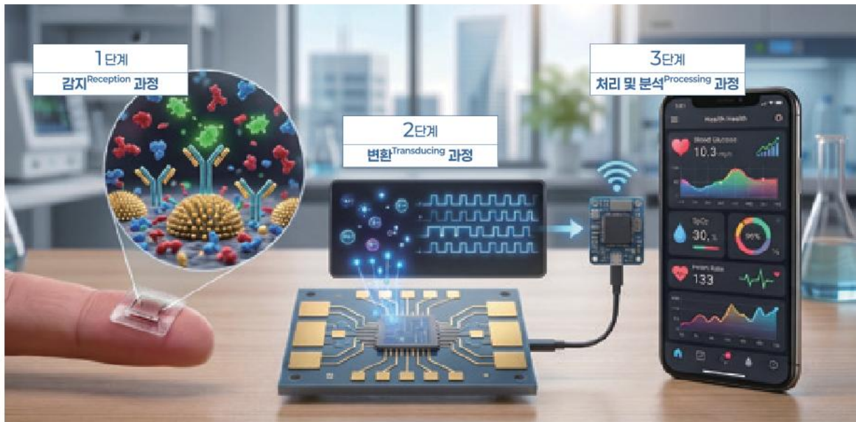
바이오센서의 생체 신호 변환 3단계 프로세스. 미세한 생체 물질이 바이오인터페이스에 닿아 반응하면, 반도체 소자가 이를 정교한 디지털 전기 신호로 변환하여 사용자에게 실시간 맞춤형 데이터를 제공한다.
