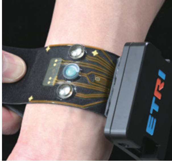
ETRI 연구진이 개발한 유연 센서 플랫폼을 활용한 다양한 웨어러블 시제품들. 가슴 부위에 부착해 심박 및 부정맥을 실시간으로 감지하는 심혈관계 모니터링 패치(왼쪽)와 손목에 착용하여 근육과 관절의 움직임을 정밀하게 분석하는 근골격계 모니터링 기기(오른쪽)다.
