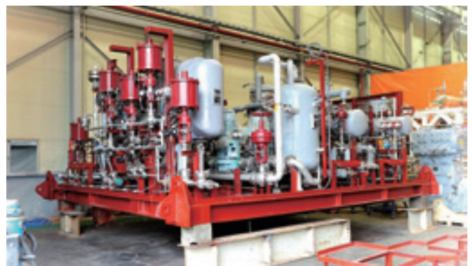
암모니아 연료 공급 시스템. 암모니아의 물성에 맞춰 저장, 이송, 압력·온도 제어는 물론 누설 감지까지 전 과정을 하나의 통합 시스템으로 구현한 것이 특징이다.
