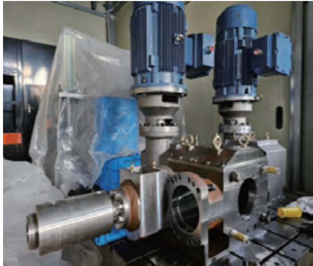
암모니아 연료 공급 시스템의 핵심 기어재인 고압 펌프 HP Pump . 80bar 이상의 고압 조건에서 암모니아의 독성과 부식성을 동시에 견딜 수 있도록 특수 설계됐다.
