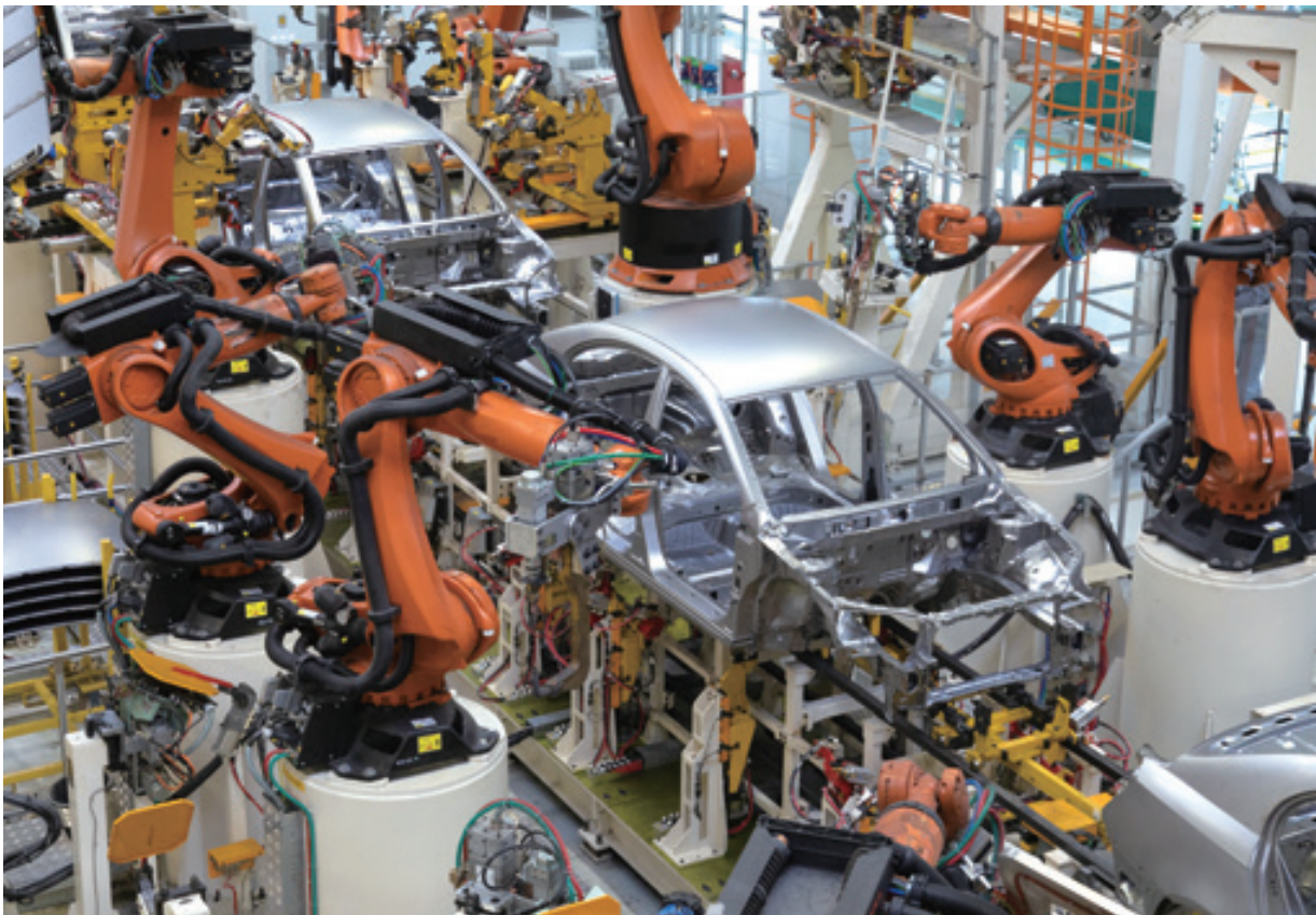
자동차 제조 라인의 로봇들이 실 새 없이 차체를 조립하고 있다. 한국 제조업의 미래는 AI가 공정의 상황을 인지하고 스스로 최적의 제어를 수행하는 ‘자율제조’에 달려 있다.
