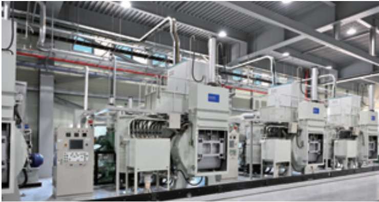
폐모터와 폐자석에서 희토류를 회수하는 건식 정련 공정 장비. 친환경적이고 안전한 기술로 핵심 소재를 재활용해 희토류 공급망 안정화에 기여한다.
