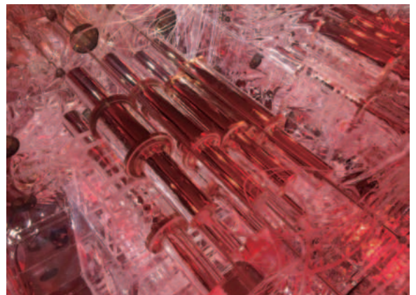
양양 COSINE-100 차폐체 내부의 NaI(Tl) 검출기 사진. 현재는 정선 예미랩으로 이전하여 추가된 검출기와 함께 암흑물질을 기다리고 있다.
