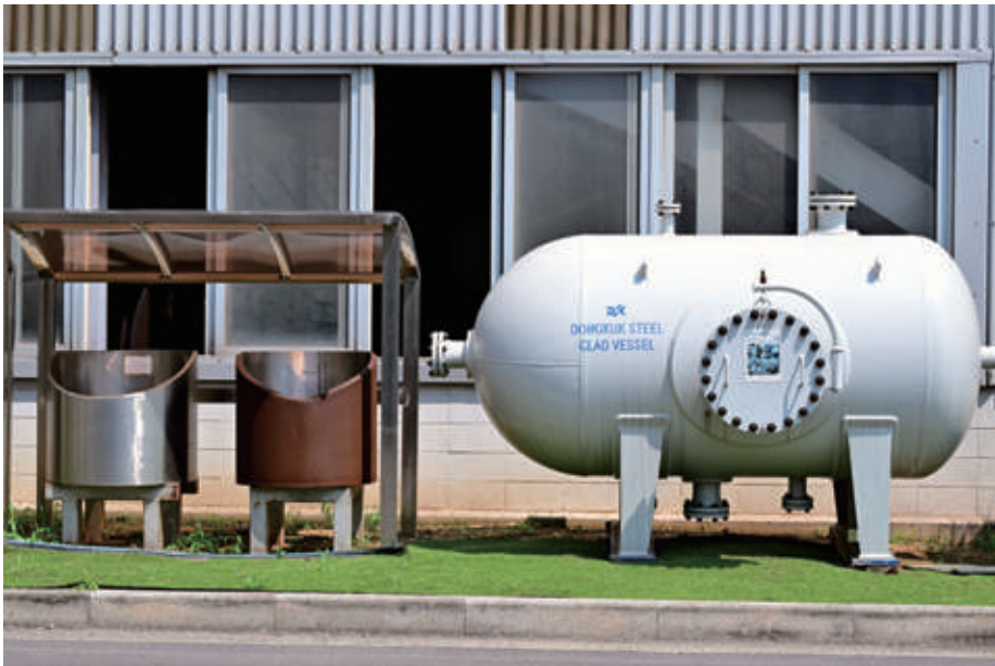
클래드 후판을 이용한 부품 소재 시작품(압력용기 및 파이프).
