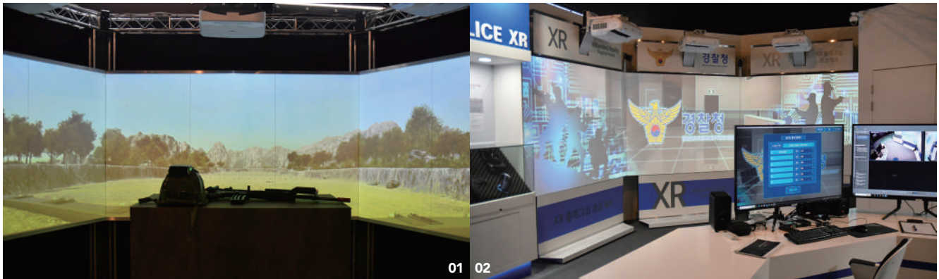
01 XR 기반 과학화 사격훈련 시뮬레이터 MARS. 헬멧에는 센서가 달려 있어 사용자가 고개를 돌리면 그에 맞게 화면도 바뀌는 방식이다. 02 XR 기반 복합 테러 대응 교육·훈련 시스템 POLICE XR. 권총과 테이저 건 등의 체포용 장비도 재현돼 있다. 03 VR 소름이 있는 디지털 파빌리온 외부 전경. 04 전시장 입구.
