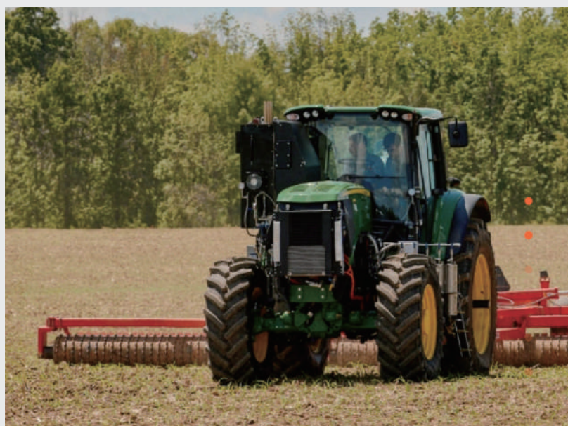
<그림 6> 암모니아, 연료전지 구동 농업용 트랙터.
