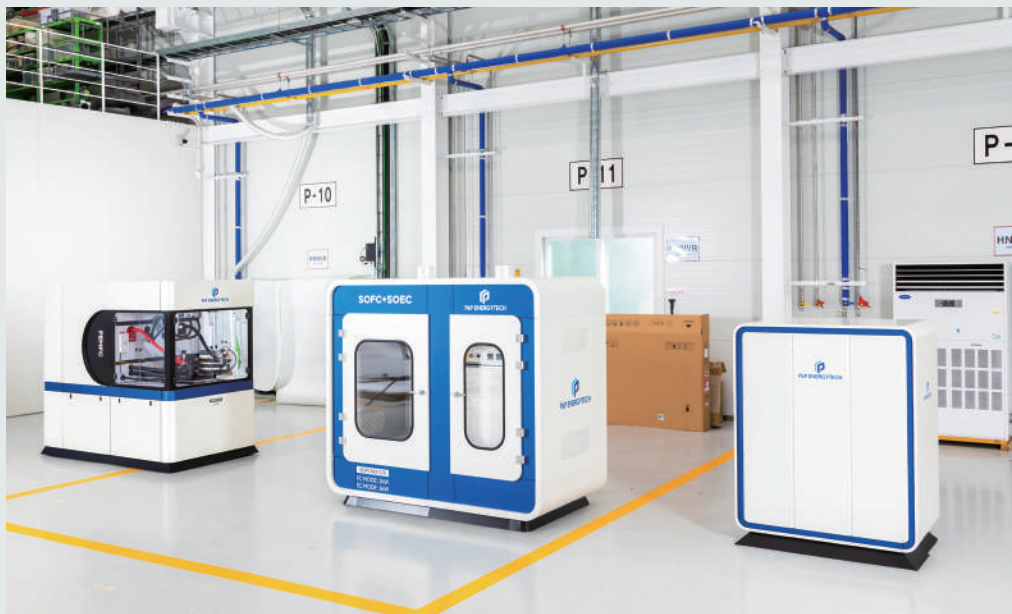
(왼쪽부터) 고분자 전해질 연료전지 스택 평가 장치, 고체 산화물 연료전지 및 수전해 겸용 스택 평가 장치, 고체 산화물 연료전지 시스템.
