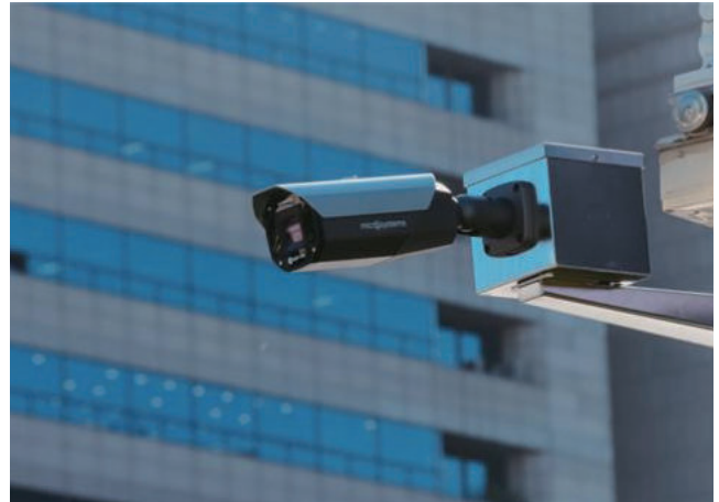
마이크로시스템의 전자식 자가 세정 기술이 적용된 CCTV 카메라.
