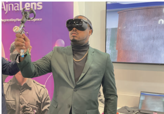
아즈나렌즈의 VR 직업 훈련 장비를 활용해 스프레이 페인팅을 실습해 보는 참가자. 스프레이건 형태의 컨트롤러로 실제처럼 페인트를 분사하는 연습을 할 수 있다. 훈련이 끝나면 작업의 정확도, 시간 등이 측정돼 점수로 나온다.
