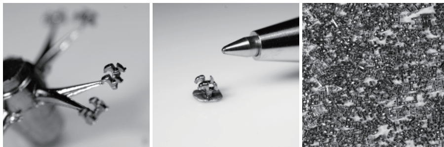
<그림 9> RDF 공법으로 제조된 교정치료용 GM281 합금 브래킷 시제품 출처 : Glassmetal Tech
