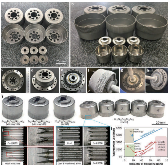
〈그림 11〉 비정질 합금으로 제조된 플렉스플라인(Flexspline) 출처 : Scientific Report, Hofmann et al.(2016)
