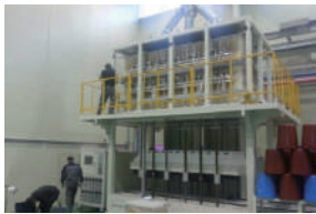
• Box & Elevator type, 3m 3 • Max Temp. 1650°C
