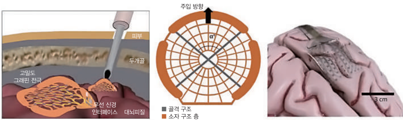
주사기 주입형 뇌신호 측정 및 자극용 그래핀 전극
