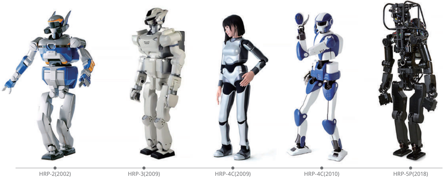
〈그림 4〉 AIST와 가와다공업이 공동 개발한 휴머노이드 로봇 HRP 시리즈
