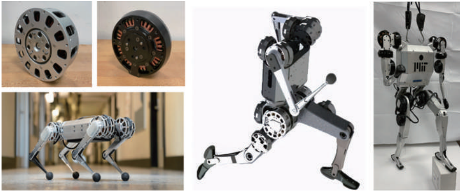
〈그림 11〉 MIT에서 개발한 QDD 기반의 미니치타(왼쪽)와 현재 개발 중인 MIT 휴머노이드(오른쪽)
