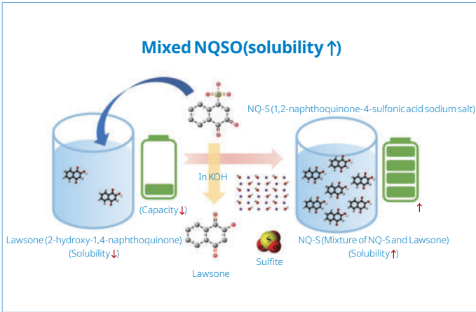
혼성 나프타퀴논 화합물(NQ-SO)의 합성에 의해 급격히 증가된 양극액(Anolyte) 커패시터 메커니즘
