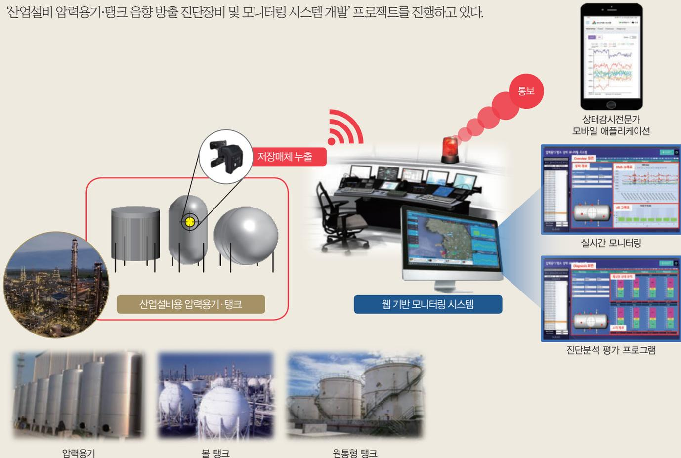
산업설비 압력용기·탱크 음향 방출 진단장비 및 모니터링 시스템 개발 개념도
