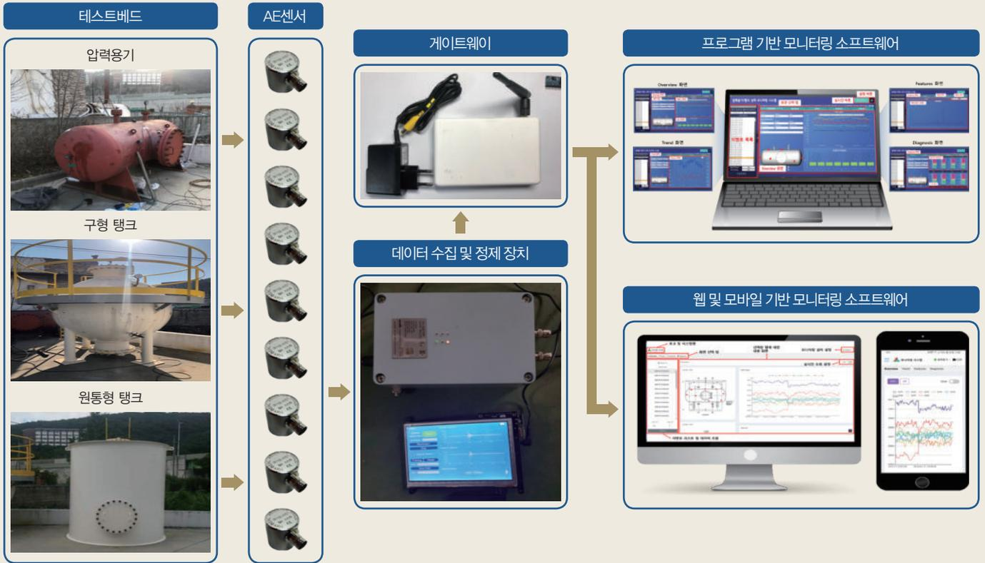
압력용기·탱크 음향 방출 모니터링 및 진단 시스템 개발
