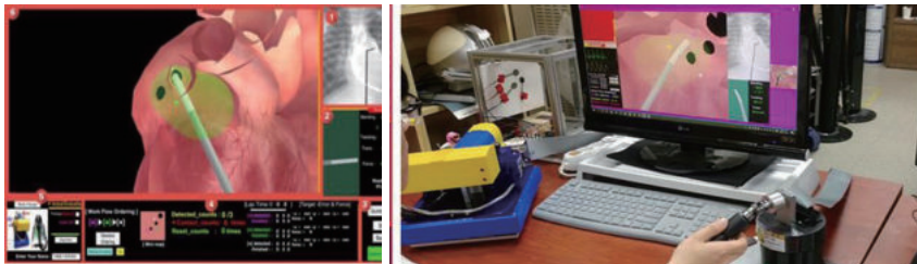
〈그림 1〉 가상 전극도자절제술 시뮬레이션(왼쪽), 햅틱 마스터를 이용한 조작(오른쪽)
