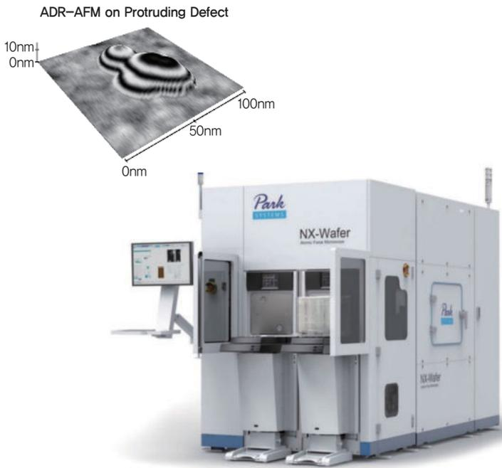
**본** 프로젝트를 통해 AFM 측정을 자동화하고 이전에 시간이 많이 소요되던 작업 흐름을 단순화해 속도를 높였다. 단순화한 작업 흐름 중에는 광학결함위치측정장비(AOI)로부터 결함 좌표를 가져온 후 AFM으로 결함을 측정하는 과정에서 사용자가 필요 없어 인라인에서 사용 가능한 기술로 개발됐다.
