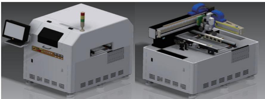
솔더 제팅용 피에조 펌프 장착된 디스펜서 시스템
