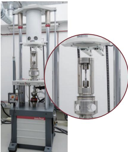
〈그림 9〉 1000bar 압력으로 수소를 저장하기 위한 용기 테스트(ROUNDROBIN 프로젝트)
