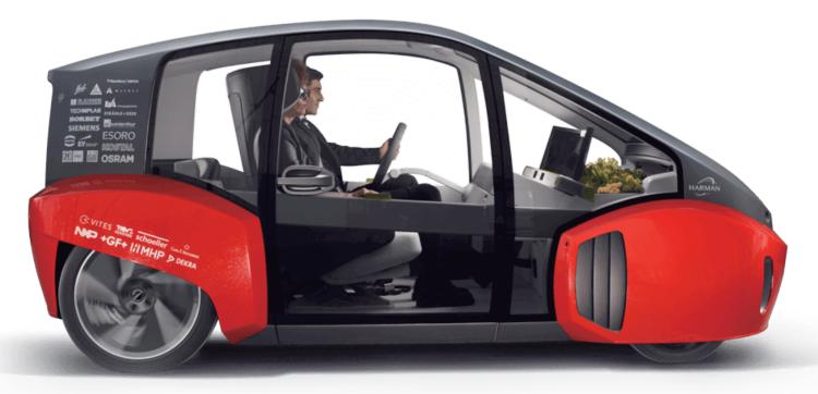
자율주행차의 영상 처리는 외부 서버와 의 연동이 아닌 자동차 내부에서 자체적으로 이뤄진다. 자율주행차에는 각종 영상 센서가 부착돼 있다. 자동차 내부에 영상 처리 기기가 센서에서 오는 정보를 통합하고 분석해 자율주행을 위한 명령을 내린 다. 참고로 이러한 구동 방식을 에지컴퓨팅 방식이라고 부른다.
