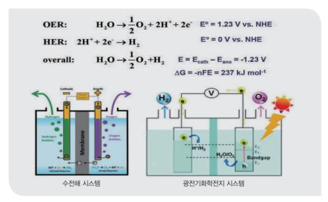
〈그림 7〉 물 분해 반응을 위한 수전해 시스템과 광전기화학전지 시스템
