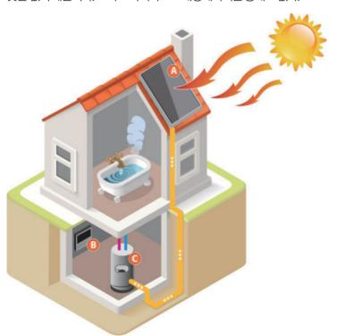
태양열을 이용한 온수 및 난방 구조 ♠ 집열기, ® 제어장치
