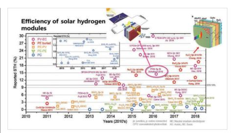
〈그림 11〉 태양광-수소 전환 효율 출처: Chem. Soc. Rev. 2019, 48, 1908
