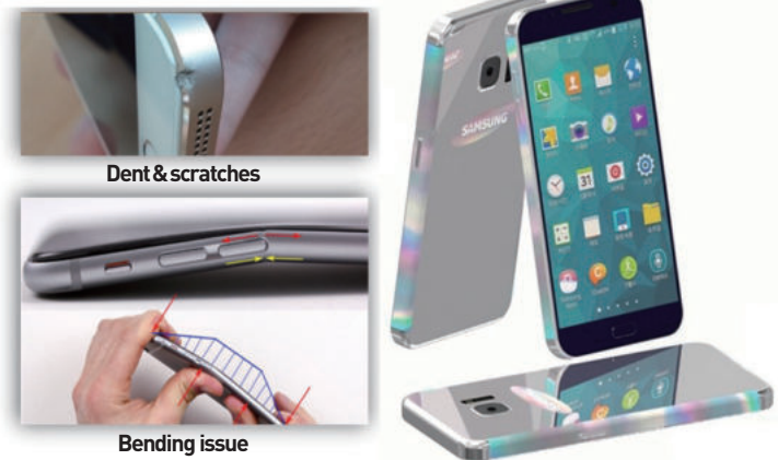
<그림 5> 현재 사용되고 있는 스마트폰 외장재 합금의 문제점(왼쪽), 자가 회복 능력이 우수한 합금을 이용한 스마트폰 외장재 모식도(오른쪽)
