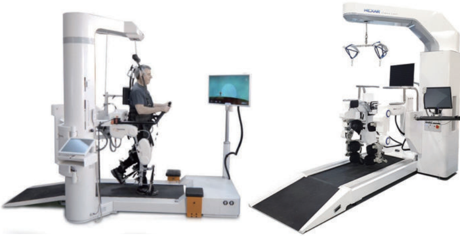
〈그림 7〉(왼쪽) 전 세계적으로 가장 많은 기관에 보급된 HOCOMA의 보행재활로봇 Lokomat, (오른쪽) 로봇 착용 편의성을 향상시킨 헥사휴먼케어의 보행재활로봇 HExo-GR(Gait Rehab.)
