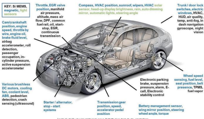
〈그림 2〉 많은 센서가 자동차의 이상 유무를 지속적으로 모니터링한다 출처 : Electronic Systems Design Engineering
