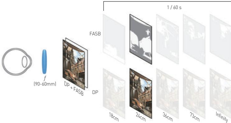
〈그림 12〉 가변 렌즈를 이용한 다평면 가상현실 장치
