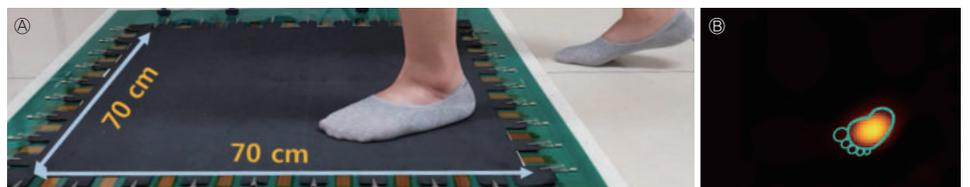
㉔ PU 나노웹을 이용한 70 x 70cm<sup>2</sup> 대면적 비격자 압력분포 감지 센서
