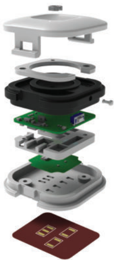
Sensor 운동량 측정을 위한 가속도센서, 체온 측정을 위한 온도센서, 운동 피로도 측정을 위한 젖산센서가 탑재되어 있다.
