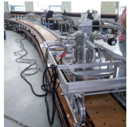
〈그림 7〉 철도기술연구원, 창원대, 서남에서 개발한 무절연 고온 초전도 자기 부상 및 추진 시스템
