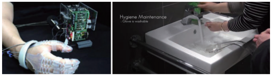
〈그림 5〉 Exo-glove Poly 외관과 물로 씻는 모습
