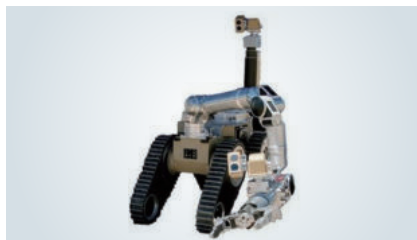
Northrop Grumman의 Andros FX - 크기 : 높이 1.4m, 폭 0.7m - 중량 : 426kg - 45도 경사, 계단 이동 - 속도 : 6km/h - 하중 : 61kg(팔길이 457mm 조건) - EO · IR 카메라 (360배 줌)
