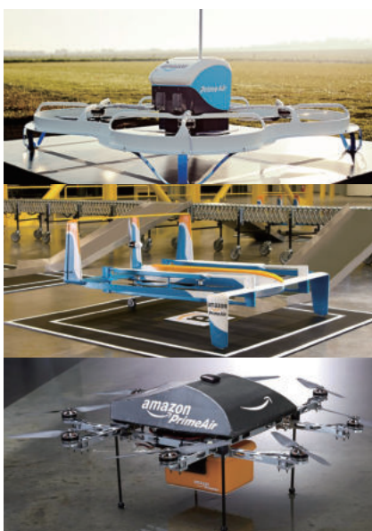
Amazon Prime Air Drone - 개발사 : Amazon(USA) - 형상 : Octocopter, Quadcopter, VTOL / pusher Hybrid - 크기(Octocopter) : 1.5m(W) × 0.5m(H) - 로터 개수 : 8, 4, 5 - 비행 거리 : 16km - 구동 전력 : 배터리 - 물품 전달 방식 : 지상 착륙
