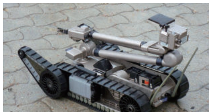
iRobot의 510 PackBo - 크기 : 높이 17.8cm, 폭 52.1cm - 중량 : 10.89kg - 60도 경사 이동 - 속도 : 9.3km/h - 폭발물 감지 센서, IR 카메라
