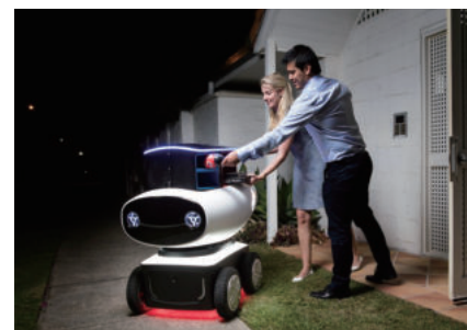
Domino's Robotics Unit - 개발사 : Marathon Robotics(Australia) - 크기 : 0.92m×0.74m×1.03m - 무게 : 190kg - 주행 반경 : 3~5km - 주행 속도 : 시간당 20km 이하 - 구동 전력 : 배터리 - Google Map 기반 GPS 추적 시스템 - LIDAR 기반 충돌 회피 시스템
