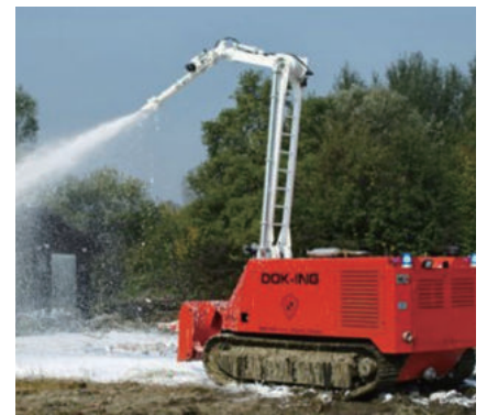
DOK-ING의 소방 육상무인이동체 MVF5 - 크기 : 3.8m×2.18m×2.1m - 중량 : 9274kg - 속도 : 시속 12km/h - 탱크용량 : 2200liter - 분사속도 : 2000L/min - 분사거리 : 55m
