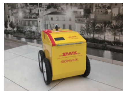
DHL 무인 배달로봇 - 개발사 : SideWalk(Lithuania) - 적재 무게 : 20kg 이하 - 주행 거리 : 10km 이하 - 구동 전력 : 배터리 - 배터리 충전 주기 : 7시간
