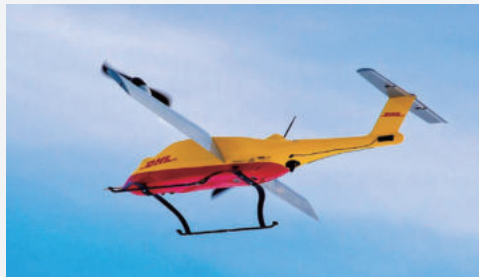
〈그림 6〉 강풍 환경에서도 택배 업무를 수행할 수 있는 날개 부착 드론 형상
