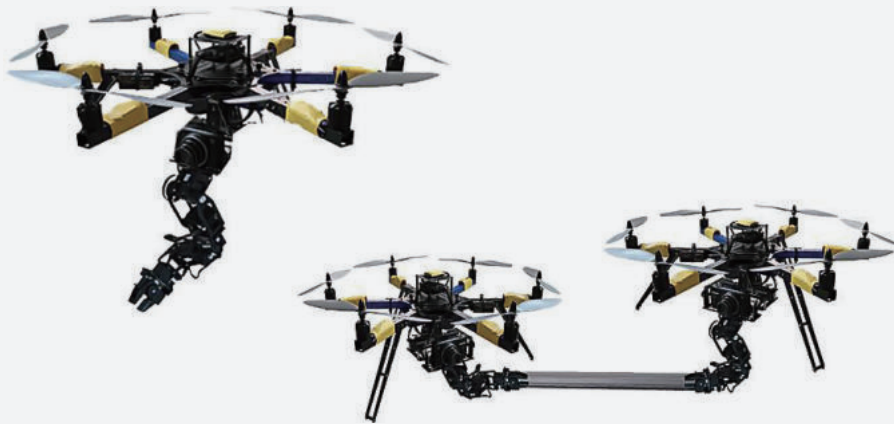
〈그림 1〉멀티로터 드론 플랫폼에 기반한 비행형 매니플레이터 시스템
