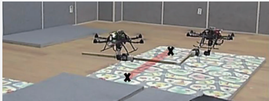
〈그림 6〉 두 대의 비행형 매니플레이터가 함께 정확한 무게를 모르는 큰 물체를 운송하는 실험
