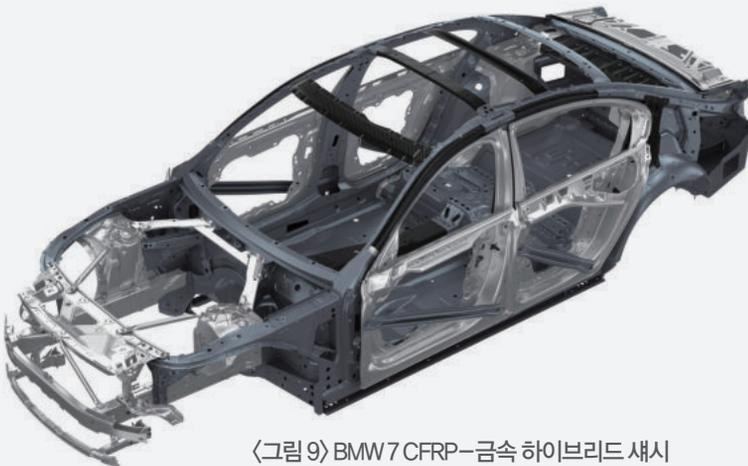
〈그림 9〉 BMW 7 CFRP-금속 하이브리드 차시
