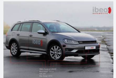
최근 테스트한 새로운 Ibeo.HAD 시험 차량 - 360도 시야 확보를 가능하게 하는 5개의 Ibeo ScaLA 라이다
