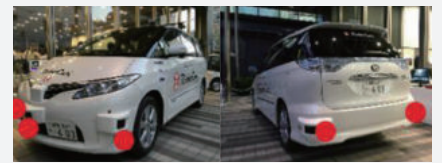
RoboCar Toyota Estima Hybrid에 장착된 5대의 Ibeo ScaLA 라이다 센서
