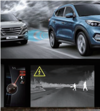
〈그림 8〉 사각지대 감지, 야간 시야 확보 기술 적용 예시
