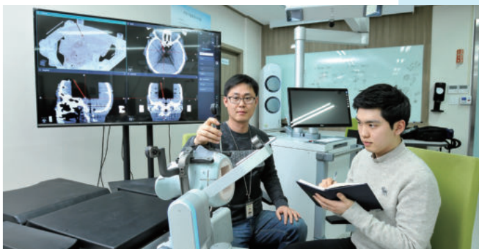
세계 최초 Single Marker 기반 고정밀 센서를 통해 수술도구 위치 정밀도를 측정하는 모습.
