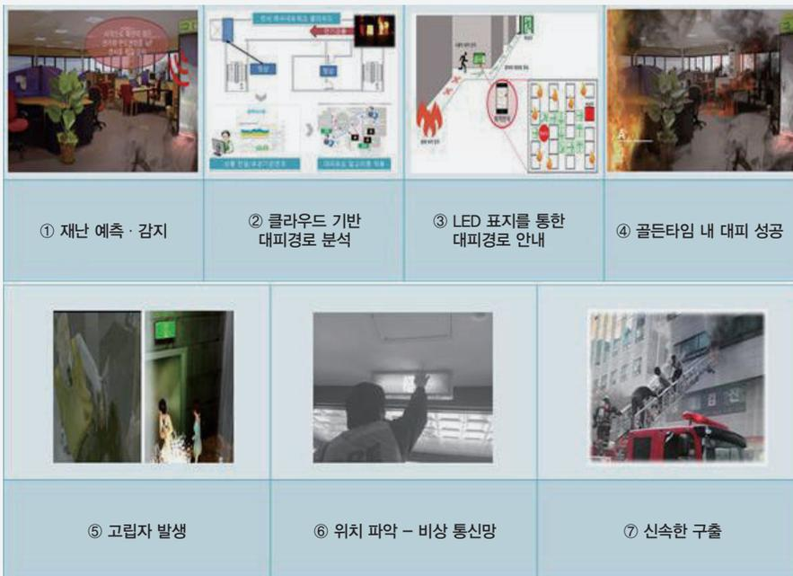
적) 재난 감지 및 대피 유도 기능을 갖춘 LED 기반의 센싱 조명 제품과 이를 무선 네트워크로 연결하는 차세대 IoT 통신 CSS-LPWA 기반 재난 통신망 기술, 재난 감지 및 분석·제어를 수행하는 클라우드 기반 종합 플랫폼 관리 SW를 모두 포함하는 종합 재난 솔루션 플랫폼이다. 이와 관련한 개발의 핵심 기술은 융·복합 LED 조명 시스템을 위한 복합 멀티 IoT센싱 기능, 화재 등 재난 상황에 강건한 로버스트 (Robust) 네트워크이다. 또한 클라우드 시스템 기반의 위험정보 공유·전파 모니터링 기능 기술, 위험 상황 기반 LED 조명 능동 제어 및 안전 대피 유도 표시 등 크게 4가지로 구분할 수 있다.
