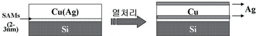
〈도 1〉 Si 기판상에 SAMs 처리 후 상부에 증착한 Cu(Ag) Layer 및 후속 열처리를 통해 표면 및 계면 사이에 석출되는 Ag층의 개념도
