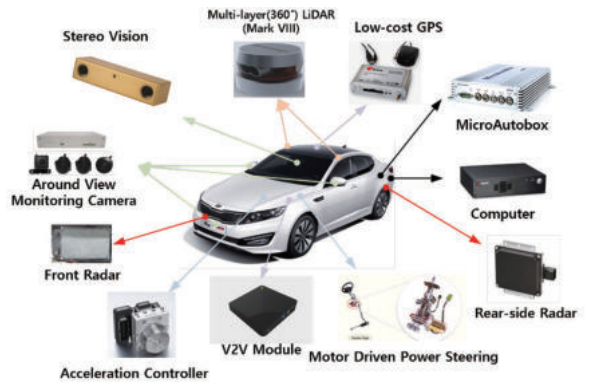
〈그림 2〉 자율주행자동차에 사용되는 레이더, 라이다, GPS, 카메라 센서 및 제어 시스템 출처 : 서울대 자율주행자동차
