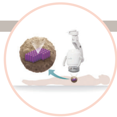
HIFU의 원리 : 돌보기로 종이를 태우는 것과 같은 원리로, 초음파 에너지를 신체 내 한 점에 집중시켜 이때 발생하는 열에너지를 이용해 암·종양 조직을 태우고 괴사시킨다.
