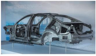
〈그림 3〉 경량 CFRP를 적용한 BMW all new 7 series
