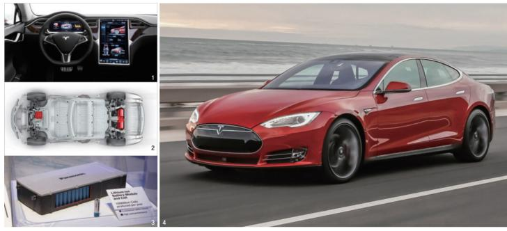
1 Model—S 차량 대시보드 2 Model—S 차량 프레임 및 모터 3 테슬라 모터스 배터리팩 4 Model—S 차량 외형
