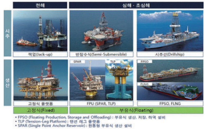
〈그림 1〉 해양플랜트 구분(용도 및 수심에 따른 구분)
