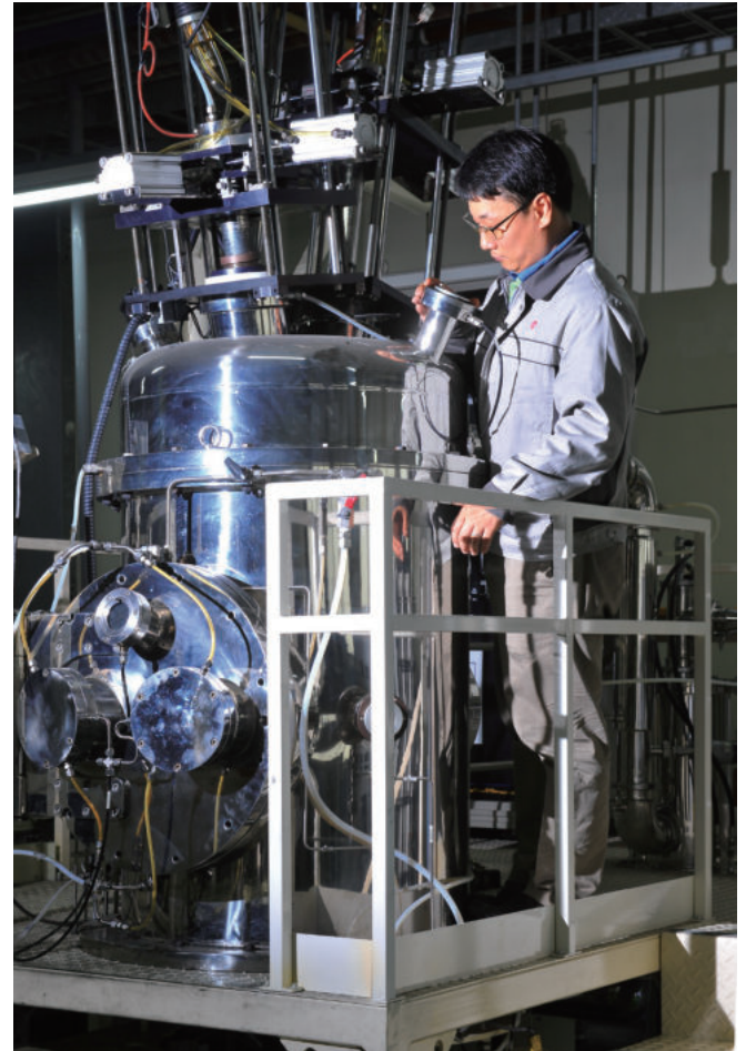
제4의 물질상태'로 불리는 플라즈마를 이용해 스퍼터링 타깃 주 원료인 초고순도 미세 금속분말을 제조하는 모습.
