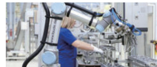
(제조) 독일 폭스바겐 공장 조립라인에 설치, 사람과 직접 협력작업을 수행하는 로봇
