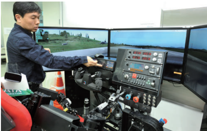
주어진 차량을 손쉽게 무인화하기 위해 개발 중인 로봇이 비행시뮬레이션을 통해 비행기를 조종하고 있는 모습.
