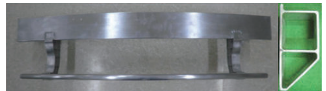
경량 알루미늄 범퍼 시스템(범퍼 마운팅형 로워 스티프너)
