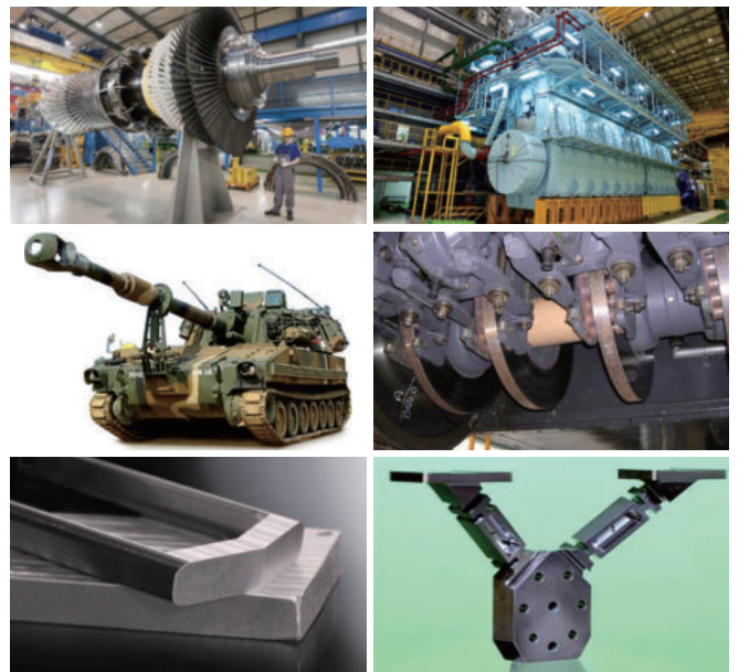
〈그림 11〉 메탈 기반 첨단소재 예, 발전소 터빈, 선박 엔진, 포신, 고속철 브레이크 디스크, 휴대폰 하우징, 인공위성 부품(왼쪽 위부터)
