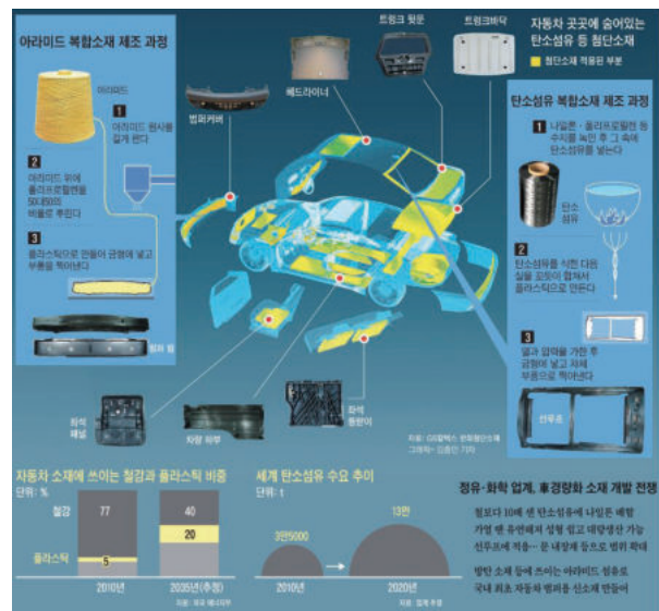
〈그림 6〉 탄소섬유 등 첨단소재의 자동차 부품 적용 예(2014, 조선일보)
