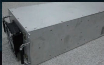
13.56MHz의 고주파 신호를 증폭하는 파워 앰프 박스 및 내부 회로. 전력 소자로는 30MHz 대역의 N-채널 브로드밴드 RF 파워 MOS-FET를 사용했음.
