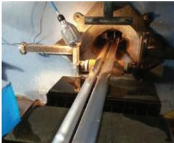
**기술내용** 현재 상용화된 대부분의 루프랙은 알루미늄 압출재와 플라스틱 사출물이 결합되어 모듈 형태로 제조되나, 본 연구는 플라스틱 사출물이 없는 알루미늄 일체형으로 부품 설계를 하고, 이를 제조하기 위한 공정을 개발하여 공정 단순화, 원가절감, 경량화를 이루며, 100% 재활용 가능한 루프랙을 개발함. 기존 루프랙의 제작 공정은 알루미늄 압출재를 제작하고 플라스틱 사출물을 별도 제작하여 결합하지만, 본 연구는 중급 강도 이상의 ECO-Al 합금을 이용하여 압출 - 벤딩 + 하이드로포밍 - 절단 - 도장 등 4단계 공정으로 플라스틱 사출·도장·체결 단계가 삭제되는 제조 공정을 개발하여, 공정 축소를 통한 원가절감뿐 아니라 공정에 소요되는 에너지를 절감할 수 있으며 부품의 경량화 효과도 얻고자 함
