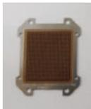
**기술내용** 테스트 컨택터는 반도체 기기 성능을 테스트할 때 테스트 장비와 반도체 기기 사이에서 전기적 신호를 연결하는 역할을 하는 부품이며 테스트 소켓이라고도 함. 실리콘 러버 컨택터는 전도성 입자가 실리콘 러버 속에서 도전성 기둥을 형성하여 상하 전기적 연결 통로가 되는 정밀한 성형 기술이 적용되는 차세대 컨택터임. 반도체 기기가 고집적화되면서 단자 간격이 점차 미세화되고, 단자 크기가 작아지면서 미세 범프(Bump) 형상으로 변화하는데, 이러한 단자에 손상을 주지 않는 미세피치 테스트 컨택터 및 고속 디지털 신호를 효과적으로 전달하는 컨택터가 필요한데 실리콘 러버 컨택터는 0.5mm 이하의 길이로도 제작 가능하여 고속 반도체 기기의 테스트에 적합한 미래 기술임. 미세 피치 실리콘 컨택터는 0.4mm 피치 이하의 반도체 소자 검사는 물론, LCD, Board to Board, Device to Board 등의 인터페이스로도 활용 가능함
