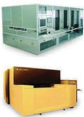
**기술내용** 다양한 크기의 PCB, FPD 및 TPD 개발에서 기존 공정은 각 크기별 포토마스크를 사용한 Photolithography 공정을 통해 PCB, FPD 및 TPD의 패턴을 제작함. 이는 각 크기별 마스크를 제작해야 하며 제작된 마스크의 수정이 불가하다는 단점과 함께 대면적을 요구하는 시장 상황에 따라 마스크 크기 역시 증가하여 제작비용 및 검사 소요시간 증가로 인한 공정비용이 증가함. 이러한 단점을 개선하기 위해 마스크 제작 없이 레이저를 이용하여 소재에 직접 다이렉트 이미징(Direct Imaging)할 수 있는 LDI(Laser Direct Imaging) 기법을 개발함. 이 기법은 기존 마스크를 대체하는 Polygon 광학헤드를 사용하여 패턴의 미세 가공이 가능하며, 패턴의 수정 및 변경에 따른 비용을 절감할 수 있음
