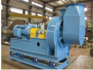
**기술내용** 생활폐기물 관로이송용 터보블로어는 전체 생활폐기물 관로이송 시스템에서 소요되는 에너지의 90% 이상을 소비하기에 전체 시스템의 에너지 절감을 위해 터보블로어의 고효율 설계가 중요함. 터보블로어의 고효율화를 위해 블로어 기본 설계 프로그램 구축, 설계변수 최적화, 최적설계 인자의 데이터베이스 구축, 실물 성능평가 시뮬레이터 구축 및 컴퓨터를 이용한 수치 시뮬레이션을 이용한 성능평가 기술을 개발함. 또한 쓰레기 투입구 수백 개와 터보블로어 사이 거리에 따른 쓰레기 흡입 압력 변화에 대응하여 공기 흡입 압력을 생성하기 위해, 5~7대의 터보블로어를 직렬 연결하여 연동 운전할 필요가 있음.
