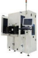
**기술내용** 기존의 EFEM은 Wafer Transfer 로봇 전체가 주행 축으로 이동하므로 FFU(Fan Filter Unit)의 층류를 교란하고 주행 축에 의한 Particle 발생 소지가 있어 고정정 EFEM으로 부적합할 수 있어 주행 축을 사용하지 않고 관절 로봇의 Inverse Kinematic으로 직선 보간을 하여 Wafer를 반송하는 EFEM 수요가 증가하고 있음. 본 과제를 통해 로봇의 주행 축을 사용하지 않는 구조로 하여 고정정도를 유지하고, 로봇 관절의 직선 보간이 필요없는 단순 구조의 로봇을 적용하여 Throughput을 향상시키고, Align 기능을 일체화하여 Foot Print를 감소시킨 EFEM을 설계, 제작하는 기술을 확보함
