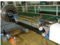
**기술내용** 발전 설비에 사용하는 터빈로터의 중심공 검사를 위해 현재 적용하는 수동, Conventional Tech., Analogue 기술을 최신 Advanced 기술로 대체함. Conventional UT 기법을 위상배열 초음파 검사(Phased Array UT) 기법으로 대체하여 A-scan 신호와 결함 이미지를 동시에 이용함으로써 결함평가 정밀도를 획기적으로 개선하고, Focusing 기법을 이용하여 미세결함 검출능을 향상시킴. 기존 검사는 UT, MT, VT 등을 각각 검사하여 검사 시간이 오래 걸리는 단점이 있음. 이 단점을 개선하기 위해 검사기법에 적용되는 최신 기술의 센서 성능을 유지하면서 소형화 및 통합화함. 통합 자동화 비파괴 검사시스템은 터빈 중심공의 표면 및 체적검사를 동시에 비파괴 검사를 수행하여 검사 시간을 획기적으로 단축함
