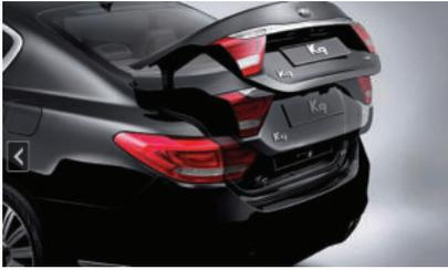
**기술내용** PTL(Power Trunk Lid)시스템은 기존 트렁크 힌지에 모터와 전자제어장치를 추가하여 자동으로 트렁크의 열림과 닫힘을 조작함으로써 소비자의 편의와 안전을 보장하고자 개발된 시스템으로 본 사업을 통해 국내에서는 최초로 국산화 개발에 성공함. 운전석 버튼 및 리모컨을 조작하여 원격으로 트렁크의 열림과 닫힘을 제어하는 기능과 트렁크 닫힘 중 사람의 신체나 장애물이 끼일 경우 이를 감지하여 다시 열리는 세이프티 기능을 포함함. 파워 트렁크 리드 시스템은 해외의 고급 차종뿐만 아니라 국내 고급 차종에도 장착되고 있으며 매년 꾸준히 수요가 증가하여 고급 차량 중심으로 장착되던 시스템이 중형급 차량까지 확대 적용이 예상되며 관련
