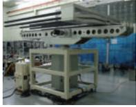
**기술내용** LCD 생산공정에서 유리기판(패널) 크기가 대형화되고 정밀화되는 과정에서 8세대 대형 유리기판 (2,200×2,500×1.1mm)을 고진공에서 핸들링 및 이송 가능한 8세대 진공로봇 개발이 요구됨. 대형 진공로봇 개발 내용은 디스플레이의 대형화에 의한 기판 자중에 의한 휨(Bending)과 처짐(Deflection) 등의 물리적 변형, 각종 공정환경에 의한 고온, 화학적 변형에 대응하는 최적의 다관절 로봇과 제어기술을 개발하여 품질 능력을 극대화함. 진공로봇이 동작하는 클러스터(Cluster) 챔버 내부는 1.5x10<sup>-7</sup> Torr 이상의 진공 상태로 고진공 환경 아래 동작하는 진공 유지 핵심 기술을 개발함.
