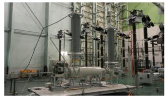
245kV 63kA GIS 시험 전경
