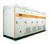
기술내용 대용량 태양광발전시스템에 사용되는 태양광 인버터의 전력 변환 효율 향상을 위해 발전량에 따라 동작하는 모듈 인버터 수를 EMS를 통해 제어하여 최고의 전력 변환 효율을 얻도록 하고, 모듈 인버터의 표준화와 규격화로 대량생산하여 원가를 절감하는 기술이며, 이러한 효율 향상 및 원가절감을 위해 모듈형 인버터에 적합한 MPPT 기술, 모듈형 인버터에 적합한 계통 연계 및 단독 운전 검출 기술, 모듈 인버터의 방열 설계를 포함하는 스택(Stack) 설계 및 양산기술 및 전력회로 설계 및 운전기술을 개발했고, 동시에 모듈 인버터의 동작시간을 카운트하여 사용되는 모듈 인버터의 동작시간이 평준화되도록 함으로써 모듈형 태양광 인버터의 수명 증가 기술을 적용하여 250kW, 500kW, 750kW 및 1000kW 용량대로 제품화를 완료함
