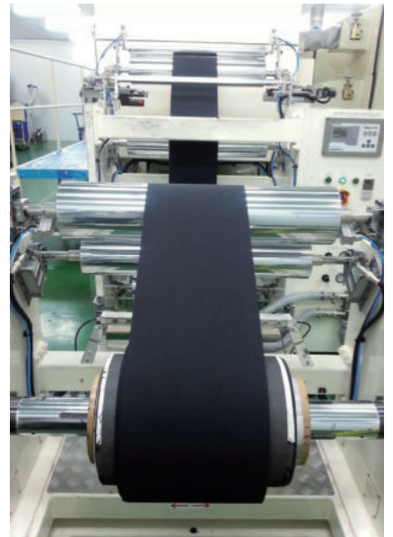
연료전지에 사용하는 기체확산층(GDL)은 탄소섬유 기반의 카본 페이퍼로 만들어졌으며, 자동차 등의 에너지를 공급하는 연료전지 등에 사용된다.
