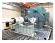
기술내용 저탄소 녹색 선박을 위한 전기 추진 선박의 핵심 기술인 지능형 전력 기자재는 전기 추진 선박의 핵심 기술로, 지능화되는 선박의 전력 환경 변화에 대응하기 위해서는 해외 의존도가 높은 지능형 전력 기자재에 대한 엔지니어링과 시험평가, 인증 등 R&D 지원체계 개발이 필요함. 이에 HILS(Hardware-in-the-Loop Simulation) 기반 선박 환경 모사를 통한 지능형 전력 기자재의 시험 기술 및 3MW급 AC 다이나모 시험 평가 기법을 개발함. 더불어 지능형 전력 기자재 인증지원체계를 개발하고 엔지니어링 국제 연계 협력을 구축함. 본 연구 과제의 핵심 기술은 녹색 선박 전력 기자재의 시험 · 인증 기술, 지능형 전력 기자재시험 평가 · 인증 지원 체계임
