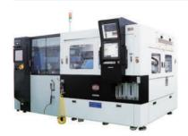
기술내용 시장 확대 추세가 확연한 BGA, QFN 등과 같은 Sawing 기반 절단 방식 장비의 고생산성 확보를 위한 제품 기술력과 폭발적으로 성장하고 있는 휴대용 디지털기기용 외장 메모리 시장에 대응하여 직선 가공과 곡선 가공을 한 장비에서 구현한 레이저 기반 범용 절단 장비 기술이 요구됨. 더불어 WLP 관련 후공정 장비 시장은 현재 시장 초입 단계에 있어 시장 주도업체가 없는 실정임. 이에 따라 직선, 곡선 CSP와 WLP에 각각 대응하여 초고속으로 절단, 비전 외관 검사, 양・불 선별 적재 공정을 동시에 수행하는 인라인 장비를 개발함
