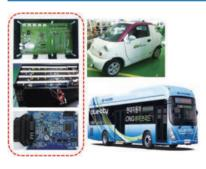
기술내용 향후 세계 자동차 시장에서 계속적인 성장과 경쟁력 확보를 위해서는 하이브리드 자동차(HEV; Hybrid Electric Vehicle)와 전기자동차(EV; Electric Vehicle) 등 친환경 자동차의 개발이 필수적임. 이에 적용할 수 있는 대형전지와 BMS의 개발은 경제 · 산업적 측면에서 반드시 확보되어야 할 매우 중요한 기술임. 이에 따라 2차전지의 전압 · 전류 · 온도를 측정하는 기술과 잔량을 실시간으로 연산하는 SOC, 상태를 예측하는 SOH, 전압의 편차를 줄이는 Cell Balancing 기술 등 소형 2차전지 분야의 BMS 세계시장점유율 1위권에 도달한 기술을 확보함
