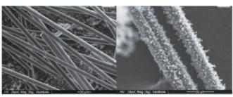
(a) Fe 나노파티클이 부착된 탄소섬유, (b) 카본 나노파티클이 성장한 탄소섬유 〈그림 7〉위스커라이징법에 의한 탄소섬유의 표면처리
