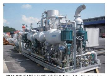
대우조선해양(주)에서 제작한 시험용 HiVAR Fuel Gas Supply System \*\* 상기 제품은 대우조선해양에서 제작한 시험용 HiVAR Fuel Gas Supply System으로 주문 생산 방식으로 생산되는 Skid 형태이며, 따라서 주문 사양 및 조건에 따라 외형 및 크기
