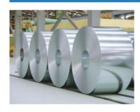
기술내용 40여 년간 사용되고 있던 비 친환경적인 기존의 자동차용 습식 도장 공정을 새롭게 이노베이션하기 위한 기술이 요구되면서 기존의 도장 공정을 완전 생략할 수 있는 새로운 도장 방식의 필요성이 제기됨. 이에 따라 친환경적이면서도 생산성이 높고 가격 경쟁력이 우수한 도장 시스템의 개발의 요구에 맞추어 본 기술을 개발함. 주요 핵심 기술은 후가공 공정의 가혹한 스트레스 및 변형(Strain)을 견뎌내기 위한 최적화된 화학적ㆍ기계적 물성을 갖춘 폴리에스테르 주수지 및 경화시스템 기술, Processability 및 Toughness의 최적화된 밸런스의 구현이 가능한 코팅시스템 배합화 기술 및 내식성 구현 기술, 선도장 강판의 접합화 기술 및 가공 특성화 기술임
