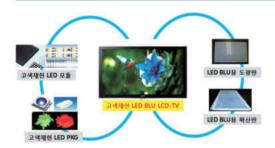
기술내용 LED Package의 등장으로 기존 광원 제품이 가지는 색재현성의 한계점을 넘어 원색에 가까운 고색의 풍부한 색을 표현할 수 있는 제품이 가능하게 됨. 이러한 고재현성의 광원에 최적화된 광학 핵심 부품 및 소재를 개발하려는 본 연구과제에서는 직하형 확산판 성능 및 에지형 도광판 성능 최적화를 달성함. 더불어 고색재현 LED PKG 성능 및 고색재현 LED 모듈 최적화도 이룸. 기술 개발에 따른 고색재현 LED LCD TV 시장의 선점으로 글로벌 TV시장의 50% 이상을 차지하는 한국 LCD 제조사들이 세계 TV 시장 점유율을 확대하여 국가 기술 경쟁력을 확고히 다지는 계기가 될 것으로 기대됨
