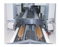
기술내용 니들 롤러를 이용한 고하중용 플랫 케이지(flat cage) 직선운동 베어링은 정밀 연삭기, 고속 프레스기 등의 베드와 주축 등의 구동 이송부에 장착되는 직선운동 베어링임. 대형 공작기계의 이송부를 높은 강성과 낮은 마찰저항(0.002이내)으로 5년에/500㎞ 이내의 정밀한 이송이 가능하게 하는 기술이 적용됨. 한 쌍의 레일 두 개와 다수의 니들 롤러, 니들 롤러의 정렬 및 일정한 간격을 유지하기 위한 케이지로 구성됨. 레일을 제작하기 위해 고탄소강의 소재를 최적의 내구 수명과 고정밀도를 갖도록 하는 열처리 기술과 연삭 기술, 초정밀·고강성의 니들 롤러를 제작하기 위한 고정밀 원통 연삭 기술, 케이지를 제작하기 위한 금형 기술 등 모든 과정을 국내 기술로 개발함
