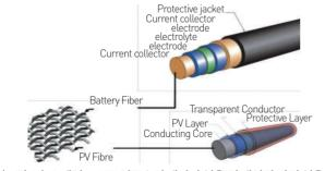
〈그림 12〉 스페인 CeNTI 연구소의 배터리 섬유 및 태양광 발전 섬유
