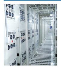
기술내용 개발된 에너지 저장장치용 고효율 충 · 방전 시스템은 친환경 자동차 산업뿐만 아니라 최근로봇 산업이나 IT 산업, 전력계통 분야에서 요구하고 있는 대용량 에너지 저장 시스템 구축에 수반되는 2차 전지 및 울트라 커패시터 등의 양산 제조에 필수적인 장비임. 개발된 고효율 충 · 방전 시스템은향후 다양한 산업에 활용이 가능한 국가 에너지 유관산업의 발전에 기여할 것으로 기대되는 기술임.핵심 기술은 2차 전지, 차량시스템 및 전기전자 제어, 전력 변환에 관한 기술과 노하우를 바탕으로에너지 회수가 가능한 스위칭 방식의 고효율 충방전 시스템임
