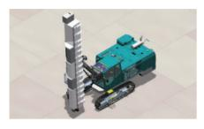
기술내용 고효율 지능형 천공 장비의 필수 요소인 대유량 Load Sensing 및 전자비례 유압제어 시스템, Drifter 및 Feed용 고효율 유압모터, 20kW급 고성능 Drifter, 고정도 위치제어 ARC, 고장력 경량 내마모 Al. Mast, 저소음 차폐모듈, 천공 모니터링 통합제어 기술, 내마모 내충격 천공공구 기술을 개발하여 선진 천공장비와 대등한 수준의 핵심 기술을 확보
