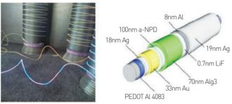
〈그림 11〉 Fraunhofer 연구소의 OLED형 발광섬유
