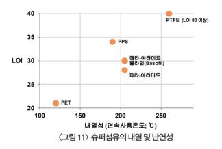
내열성 섬유는 분자시슬 내 및 시슬들 간의 반델발스력, 수소결합력,  $\pi$ - $\pi$ 상호작용 등이 강하고 분자시슬의 packing 성이 높아 유리전이온도가 높다. 한편, 사용 환경에 따라 내열성이 크게 달라지는데 예를 들면 아미이드 결합의 메타 아라미드는 습열과 고온의 산성조건에서 강도저하가 크게 발생한다. 반면에 PTFE는 대부분의 pH범위의 고온 환경에서 안정하다. 따라서 고온 환경의 화학적 조건을 살펴서 용도개발을 해야 한다. 내열성에 관한 표준규정은 없으나 일반적으로 임의의 조건에서 180일간 섬유소재를 처리하였을 때 초기 강도의 80% 이상을 유지하는 온도를 그 소재의 내열온도라 일컫는다.
