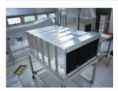
기술내용 국가차원에서 개발을 진행하고 있는 차세대 고속철도는 프랑스의 AGV, 독일의 ICE, 일본의 신칸센등이 채택하고 있는 동력분산형 추진 체계임. 이에 따른 분산형 시스템을 위한 부품의 성능 개량 기술 개발이 요구됨. 현재 주전력변환장치에 적용하려는 냉각기는 수냉각 시스템으로 냉각수 누설 시 야기되는 문제가 크기 때문에 수냉각기로 개발이 완료되더라도 이를 대체할 수 있는 히트파이프 방식의 냉각기가 필요함. 감당해야 하는 냉각용량은 10~30kW급으로, 기존 방식의 히트파이프로는 대응이 어려우므로, 새로운 개념의 고성능화된 비등식 분리형 히트파이프 개발 필요성이 제기됨. 이에 따라 개발된 철도 및 산업용
