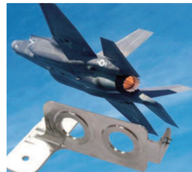
3D-Printing 기술 적용 F-35 전투기 Ti합금 Bracket
