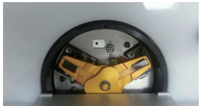
랩온어칩 기술을 기반으로 한 일회용 플라스틱 칩과 온도구배가 가능한 금속 블록, 회전이 자동으로 제어 가능한 모터를 통합한 회전식 PCR
